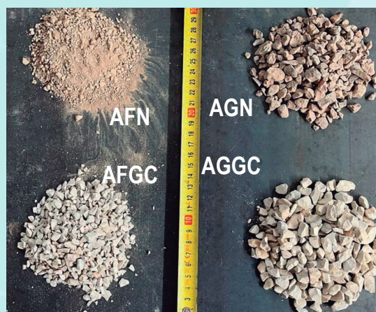
Figura 1. a) Áridos naturales en la parte superior y áridos de gres cerámico en la parte inferior. (b) Gráfico resultado del tamizado de áridos.
