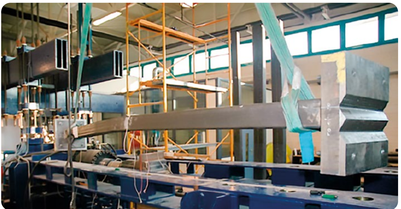
Figura 4. Pilar CFT de 3 m de longitud tras ser ensayado en las instalaciones del grupo de investigación en la Universitat Jaume I.
