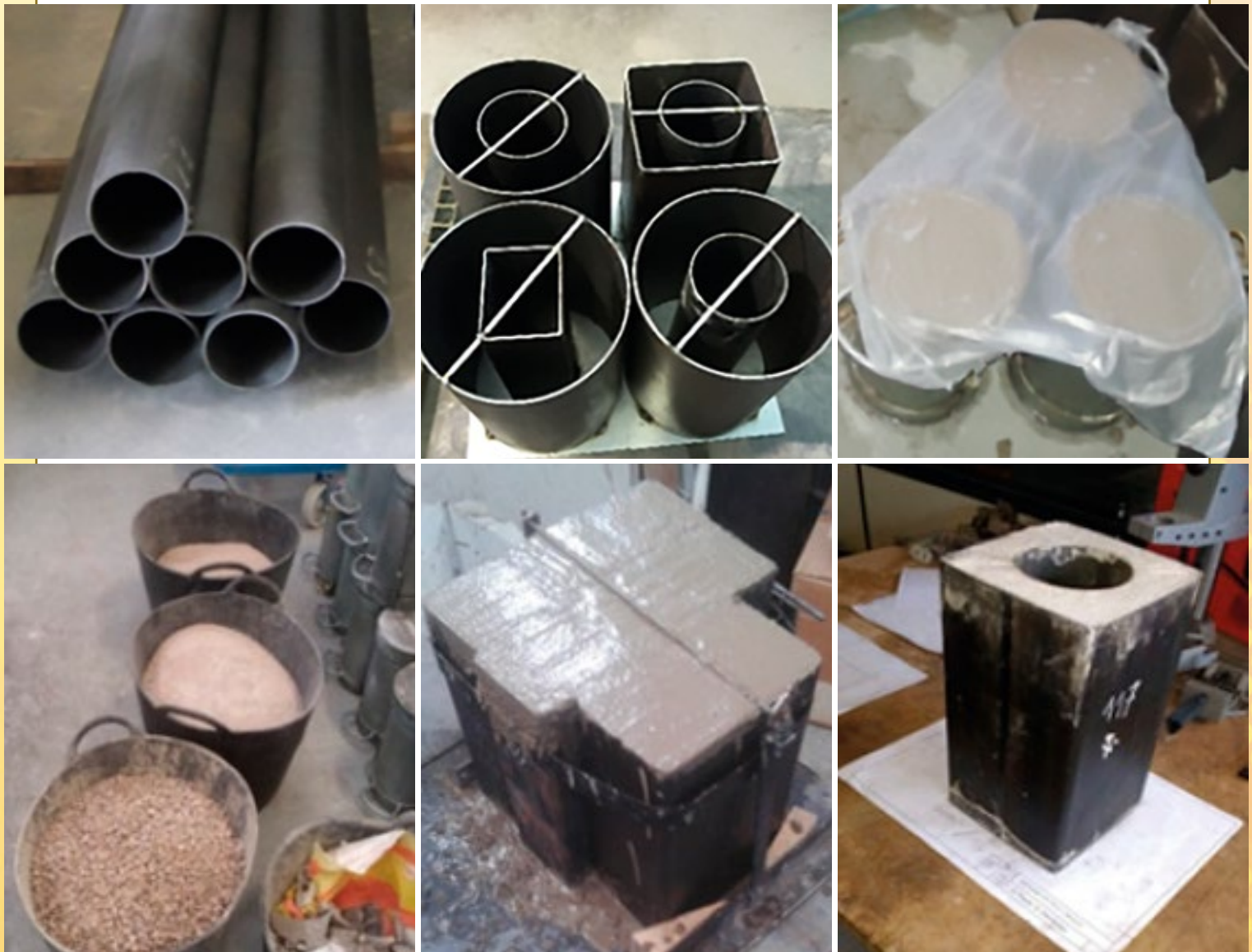
Figura 5. Proceso de elaboración de pilares cortos CFT para el estudio seccional de los mismos
